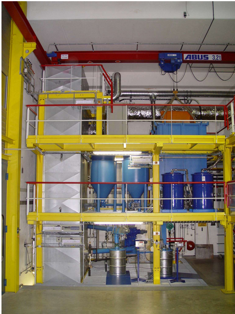
Bild 3: Fotos zur großen Wirbelschicht mit Nebenaggregaten
