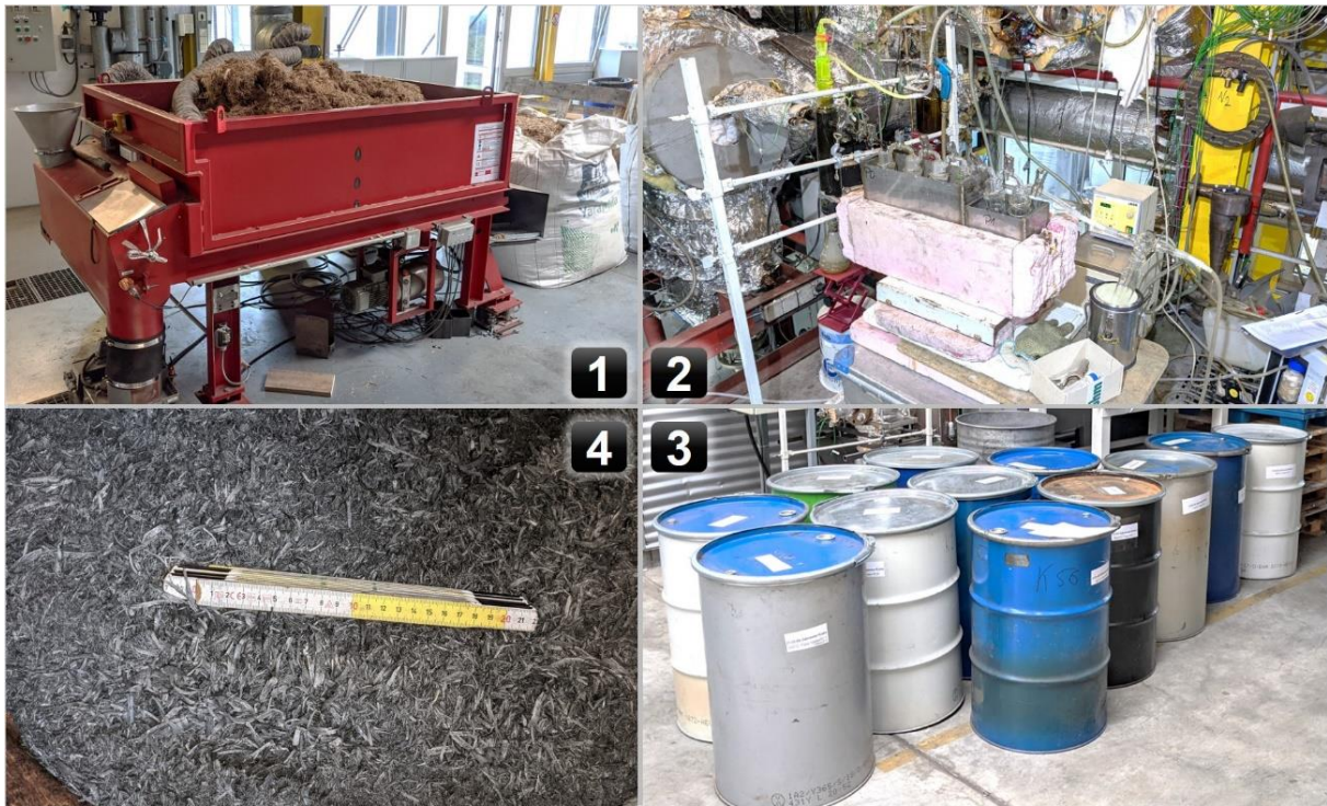
Abbildung 3-10: Fotos zu den Drehrohrversuchen: 1 Biomassevorlage-Bunker, 2 Kondensatprobennahme, 3 mit Koks abgefüllte Fässer, 4 Bagasse-Koks
