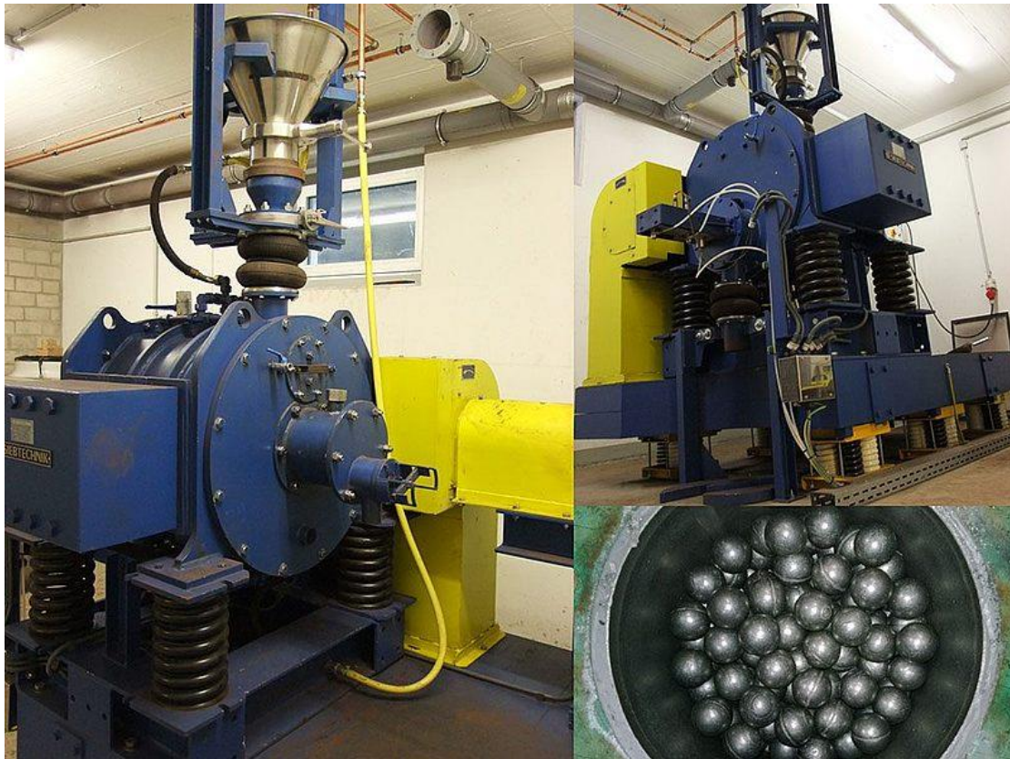
Abbildung 5-1 Exzentrerschwingmühle im CUTEC Forschungszentrum, rechts unten: genutzte Mahlkörper [CUTEC]
