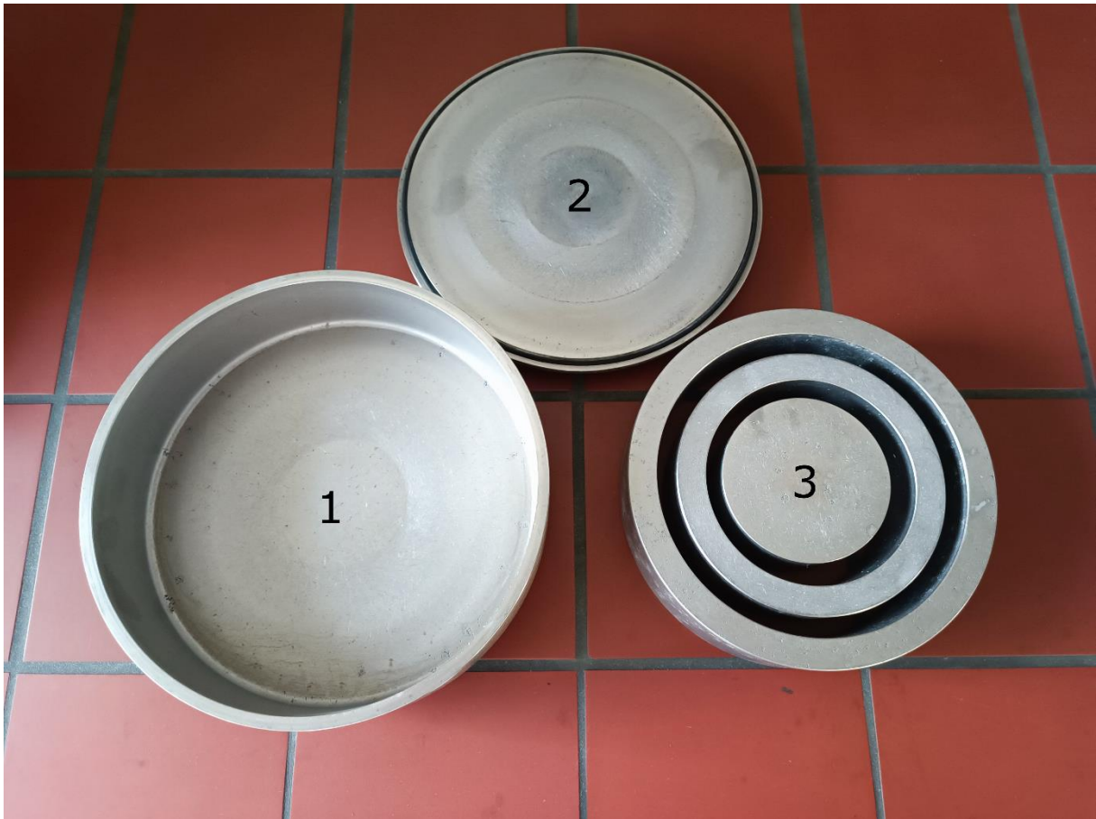
Abbildung 5-2 Mahlkörper und -gefäß der Scheibenschwingmühle, 1: Mahlgefäß, 2: Gefäßdeckel, 3: Mahlkörper
