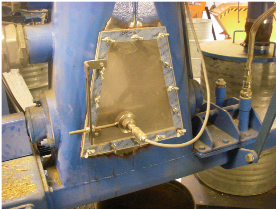
Abb. 4.3-4: Optischer Füllstandssensor im Füllbereich der Eintragsschnecke
