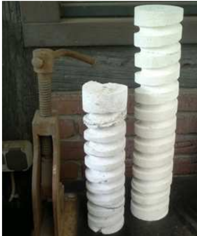
Abb. 3.2-3: Gegenüberstellung alte (li.) und neue Heizkerne (re.)
