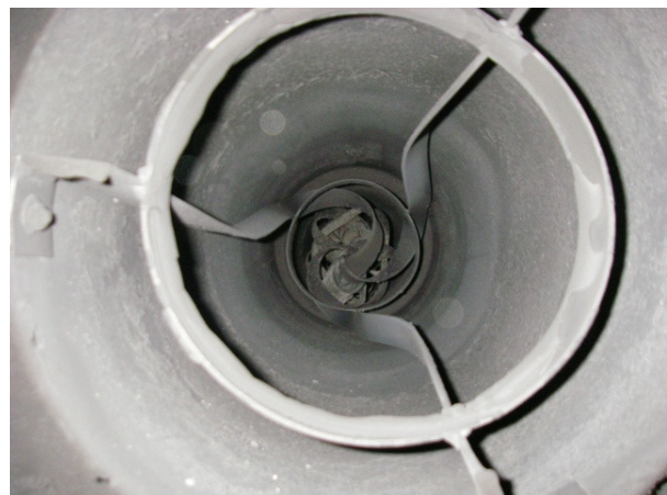
Abb. 5.4-3: Statischer Gutbett-Mischer im Einbauzustand (links) und als Knäuel im Drehrohr nach thermischer Überlastung (rechts)
