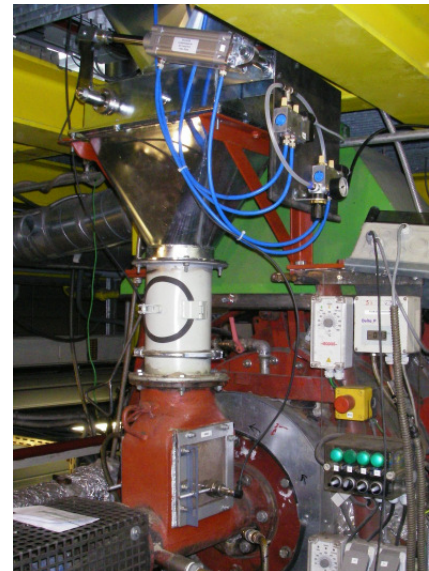
Abb. 5.4-2: Neue Beschickung mit Schubboden (links) und Doppelpendelklappen (rechts)
