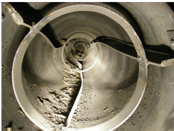
Abb. 5.4-3: Statischer Gutbett-Mischer im Einbauzustand (links) und als Knäuel im Drehrohr nach thermischer Überlastung (rechts)
