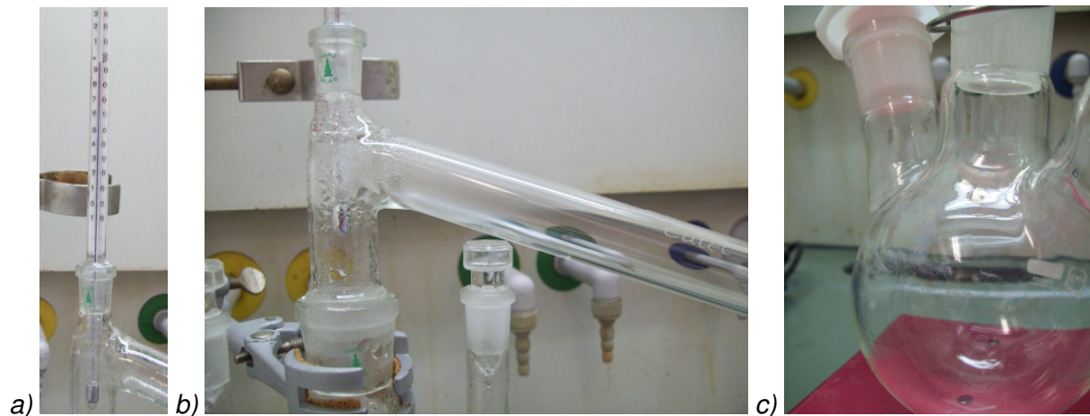
Abb. 9: Versuchsergebnisse: (a) Dampftemperatur; (b) Kondensation von Wasserdampf und Desublimation von Koffein in der Destillationsbrücke; (c) leichter Niederschlag von Koffein im Destillatkolben.
