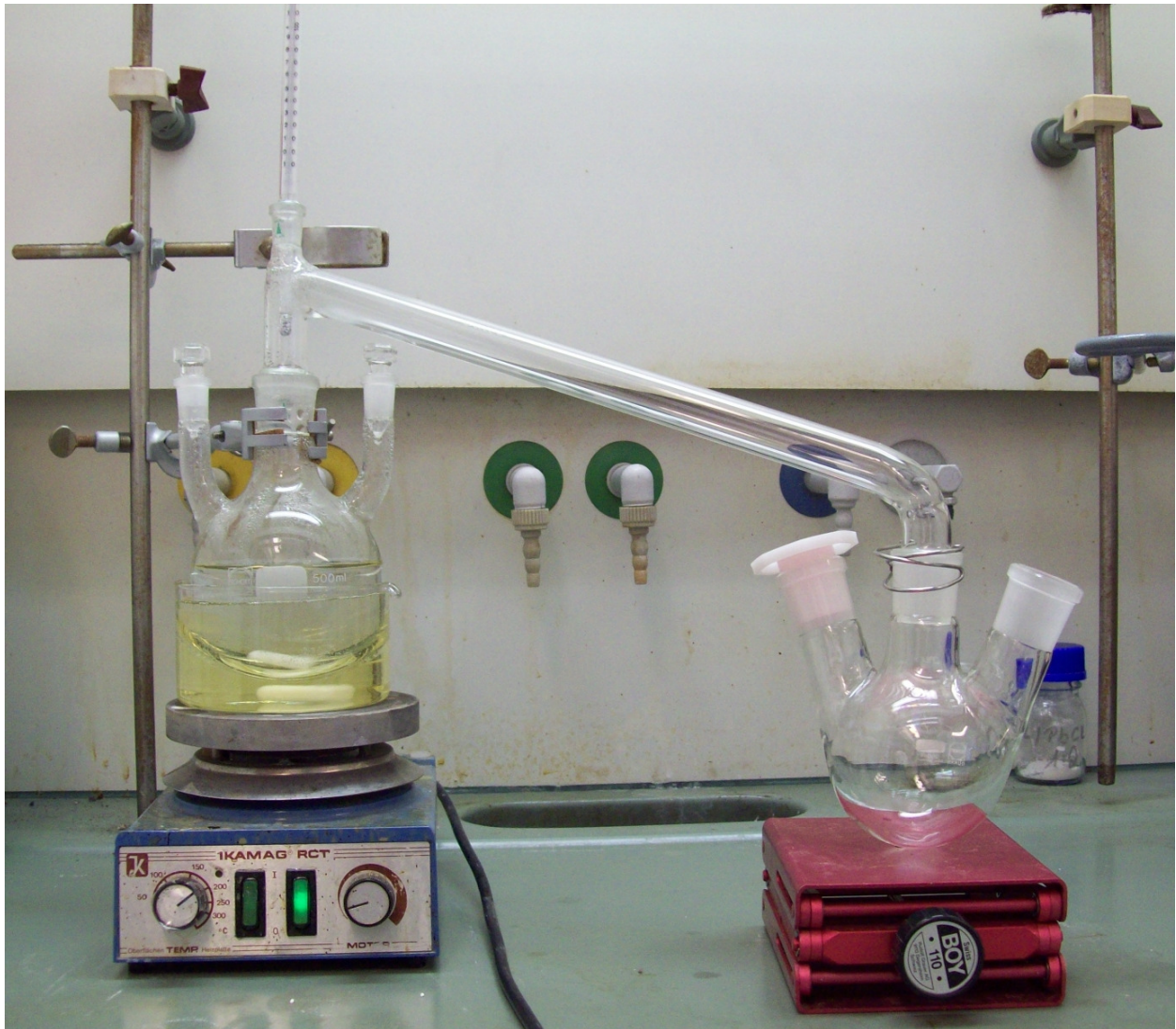
Abb. 8: Versuchsaufbau zur Überprüfung der Desublimationsgefahr.
