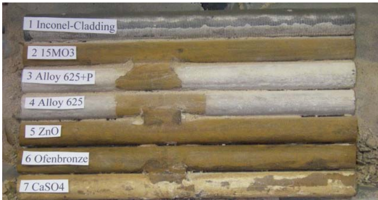
Abb. 5-16: Zustand der Rohre nach Ausbau: KVA Bern
