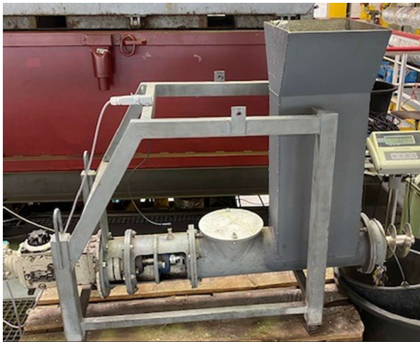
Abbildung 8: Aufbau der Additivschnecke zur Aufnahme der Schneckenkennlinie
