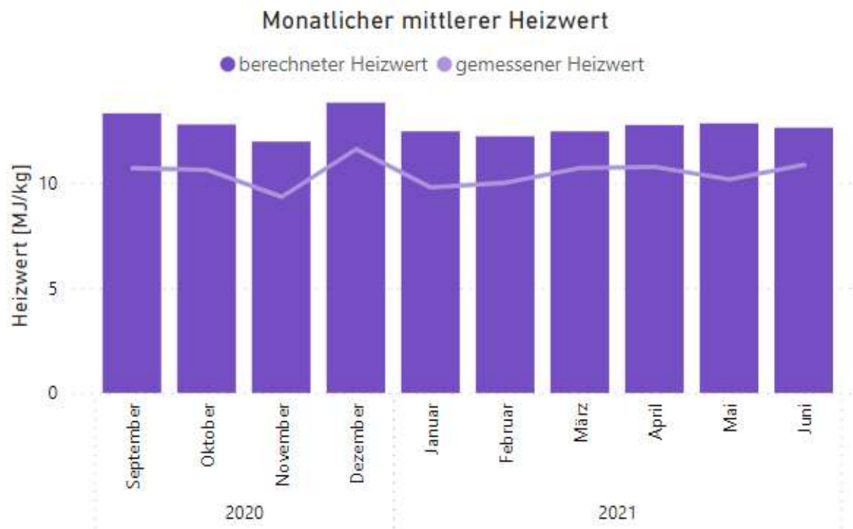
Abbildung 68: Ergebnisse des mittleren monatlichen Brennstoffheizwertes berechnet mit der erweiterten Online-Bilanzierung und aus internen Berechnungen von September 2020 bis Juni 2021 im MHKW Coburg
