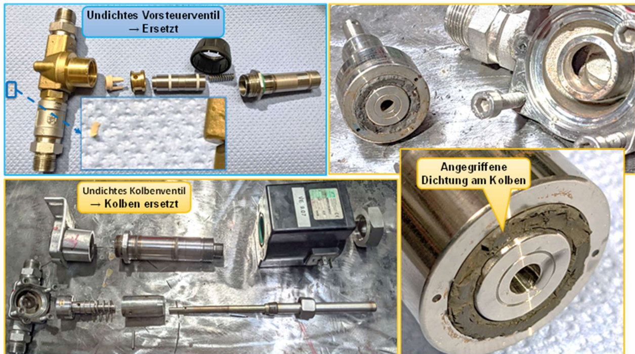
Abb. 7.4-6: Beispielhafte Darstellung zweier als undicht erkannter Ventile während des Inbetriebnahmeprozesses
