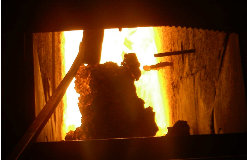
Abb. II.5.2.1-2: Schlackebrocken beim manuellen Austrag aus dem Feuerraum
