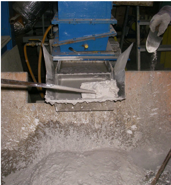
Abb. II.5.2.1-1: Nassentschlacker bei Kalkzugabe
