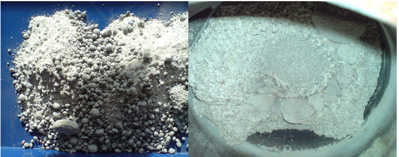
Abb. II.5.1.1-1: Agglomeriertes Bettmaterial nach Überschreiten des Ascheerweichungspunktes und verbackenes Bettmaterial im unteren Teil der Wirbelschicht, direkt über dem Düsenboden
