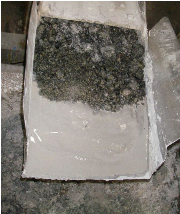
Abb. II.5.2.1-3: Austrag Nassentschlacker ohne Kalkzugabe
