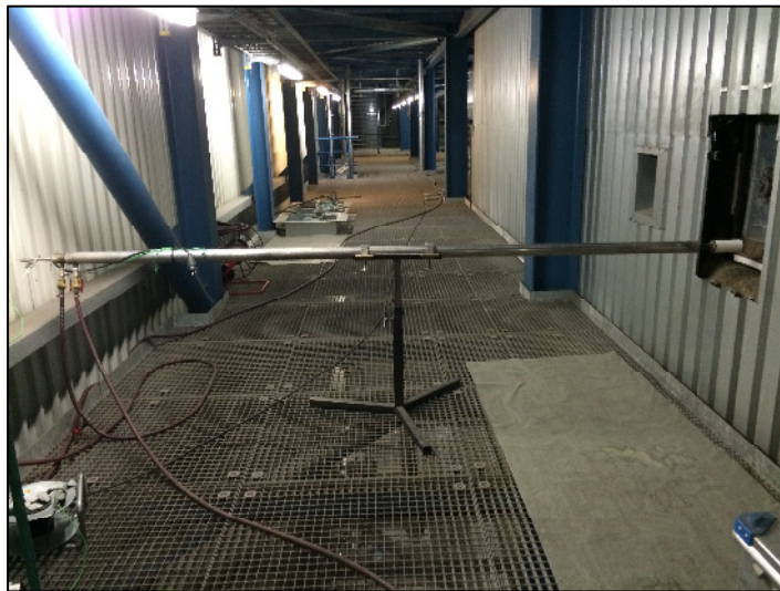
Abbildung 4.6-3: Foto der Messsonde beim Betrieb an der linken Kesselseite (Messöffnung 4) sowie eine schematische Darstellung der Messpunkte über dem Querschnitt unterhalb der SNCR, Linie 4.
