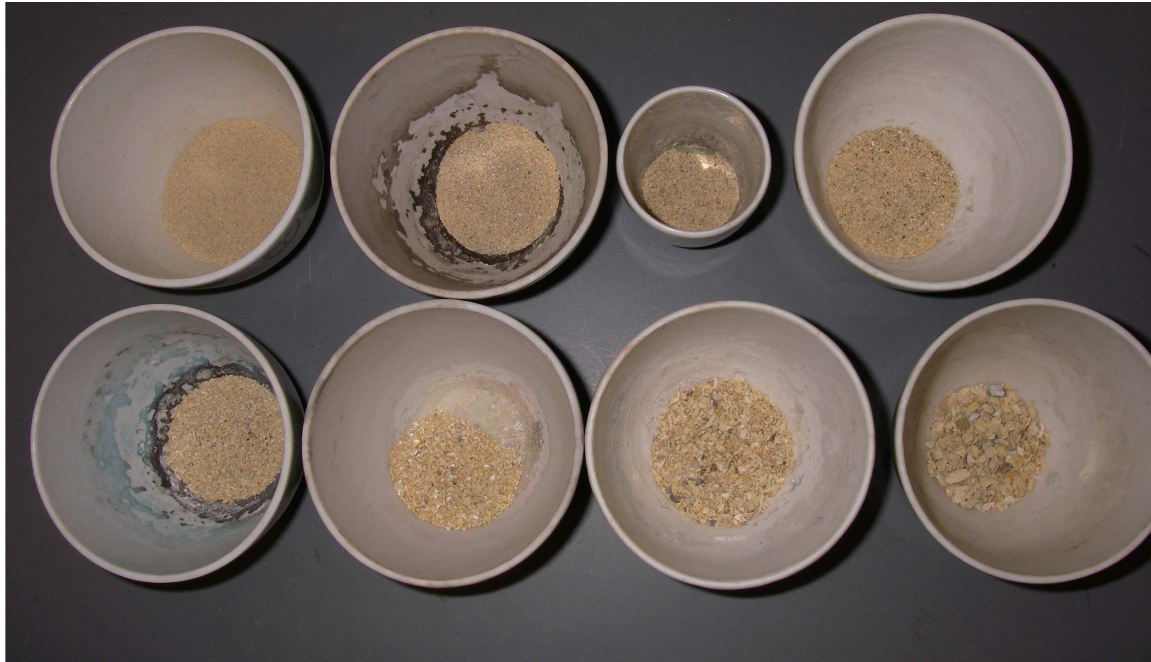
Abb. 2-2: Glührückstände der einzelnen Siebfraktionen (von links oben: <200µm, 200-250 µm, 250-355 µm, 355-500 µm, 500-710 µm, 710-1000 µm, 1000-2000 µm, >2000 µm)
