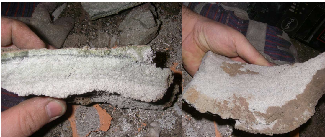
Abb. 6-2: Verbackungen nach Entfernung aus der Wirbelschicht
